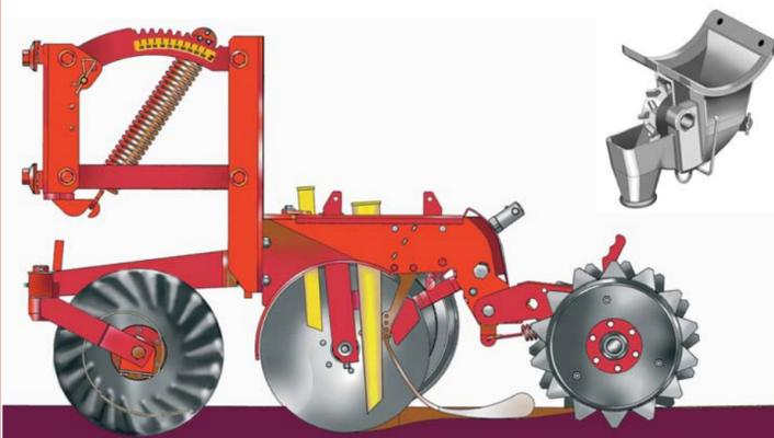
permet de travailler en conditions difficiles sans risque de bourrage. Une languette en plastique rattrape la graine dans le sillon (coup de pouce du jardinier) . Un jeu de roues en V avec une correction de l'angle d'attaque pince le sillon en laissant de la terre fine au-dessus de la ligne de semis.
