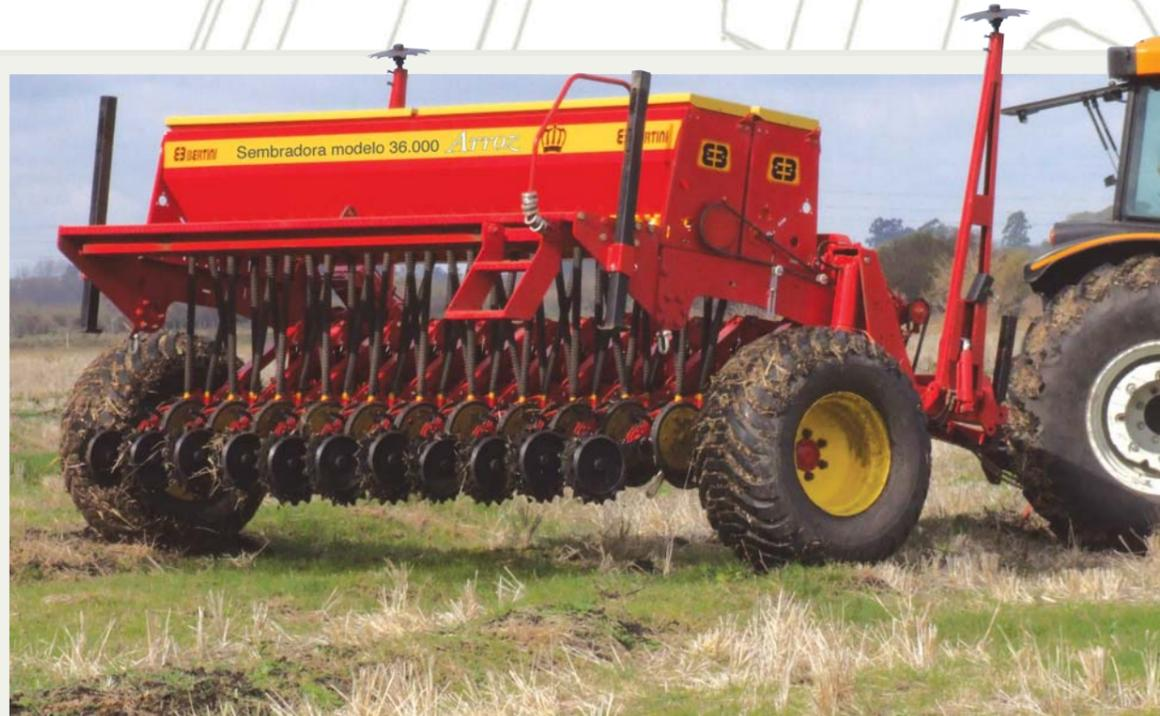
La sembradora modelo 36 mil esta equipada con cubierta de alta flotación 550/60-22.5 ancho de pisada 55 cm., fundamental avance en sembradora de arroz:
