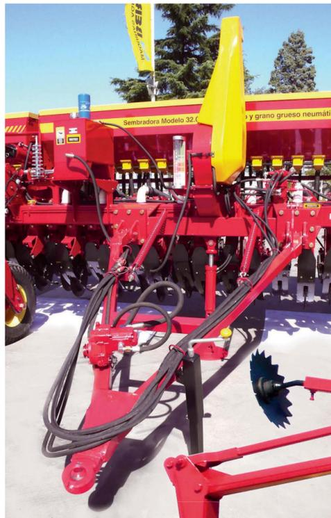
▶ Combinada para grano grueso neumático. Turbina movida con motor hidráulico (sin cardán). Distancia entre surcos de 20 cm. a 2 metros.
