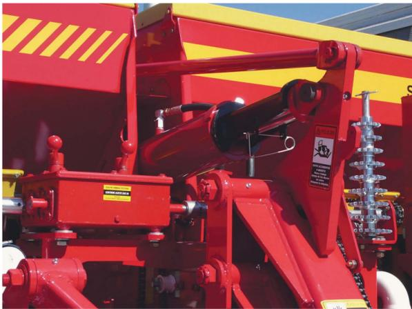
▶ Levante hidráulico de 20 ton. por cilindro. Permite un despeje de 55 cm.
