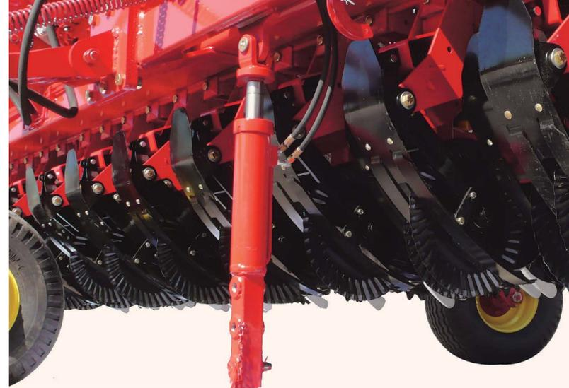
▶ Gato hidráulico para el giro de las ruedas de posición siembra a transporte y viceversa.
