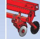
**CUCHILLAS FLOTANTES AL CHASIS** FLOTANTES A LA BARRA Y DOBLE DISCO APLICADOR DE FERTILIZANTE AL COSTADO DE LA LINEA
