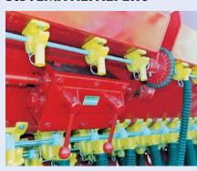
El sistema de dosificador de alfalfa es de máxima precisión. Los dosificadores plásticos helicoidales movidos por una caja de velocidad, brindan exactitud en el tiempo y posibilitan mínimos desde 1Kg. por hectárea. La profundidad deseada se logra con la regulación continua que dispone el tubo de descarga en el tren de siembra.
