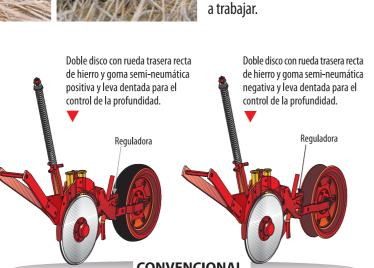
Una buena siembra directa se logra haciendo que la semilla quede a la profundidad deseada, constante y con un contacto íntimo suelo-semilla. El tren de siembra BERTINI logra hacer una cama de siembra con una cuchilla ondulada (dura fluted, wavy, rippled o turbo) que corta y clava en los
